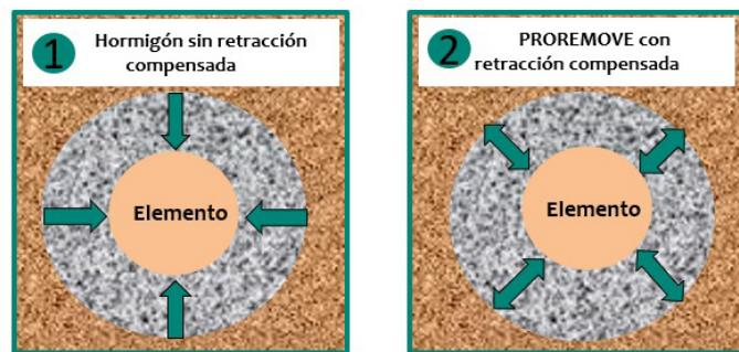
Esquema de funcionamiento de la retracción compensada:
